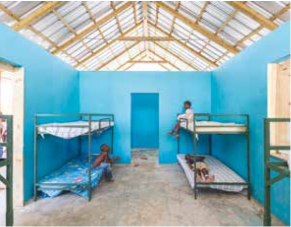
Bonaventura Visconti di Modrone, orphelinat parasismique, Haïti (2016) L’orphelinat est érigé sur une dalle de béton armé, nécessaire dans cette région particulièrement sujette aux séismes. Adapté au climat tropical humide d’Haïti, le bâtiment présente de grandes toitures ventilées. Tout en supportant des panneaux solaires, elles qualifient la nature des espaces plus ou moins privés qu’elles surplombent. In this earthquake-prone region, the orphanage is built on a reinforced concrete slab. Designed for Haiti’s humid tropical climate, its large, ventilated roof surfaces are covered with solar panels ; they create shaded spaces, some private, where children can be with their peers or spend time alone.
